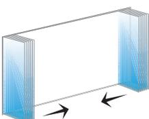
Système coulissant à la française – ouverture des deux côtés, fermeture au milieu.
