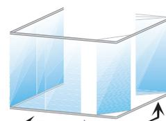
Installation à angle – angles entièrement vitrés sans cadre pour les balcons ou loggias, par ex.
