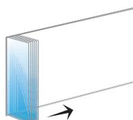
Structure simple – ouverture d'un ou des deux côtés, fermeture vers la gauche et/ou vers la droite.
